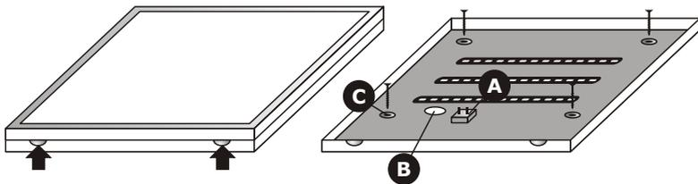
3. Разметьте установочные отверстия, приложив светильник к опорной поверхности.
